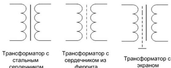
**Рис. 1.5.1.** Обозначение трансформаторов на принципиальных схемах.
