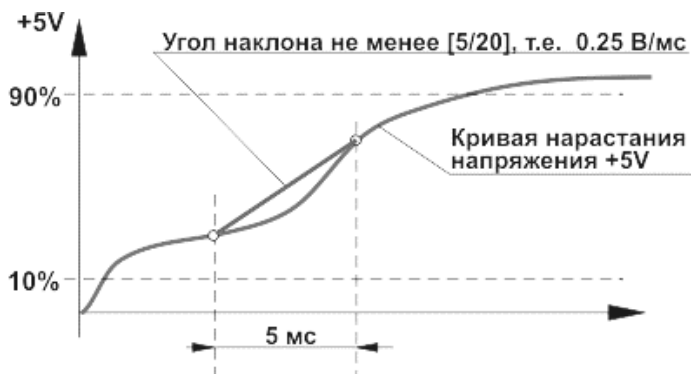
Рис.1.23.7. Максимальная скорость нарастания выходных напряжений на 5 мс интервале
