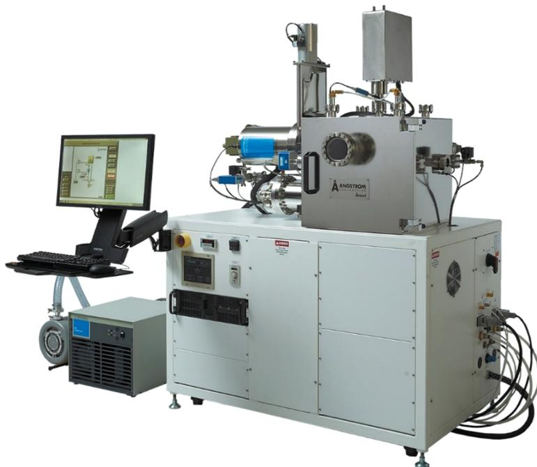
**Рис. 1.50.** Типовая установка для нанесения тонкопленочных покрытий
