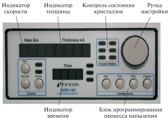
Рис. П5.12. Измеритель толщины и скорости напыления пленок: 1 – ручка; 2–4 – индикатор скорости, толщины и времени соответственно
