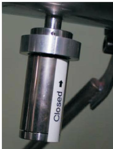
Рис. П5.11. Рукоятка регулирования положения крышки магнетрона
