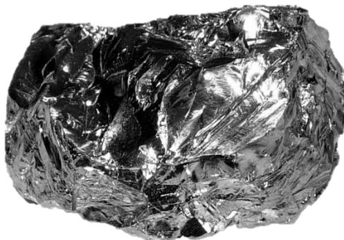
**Рис. 1.3.2.** Поликристаллический кремний (чистота 99,9%)
