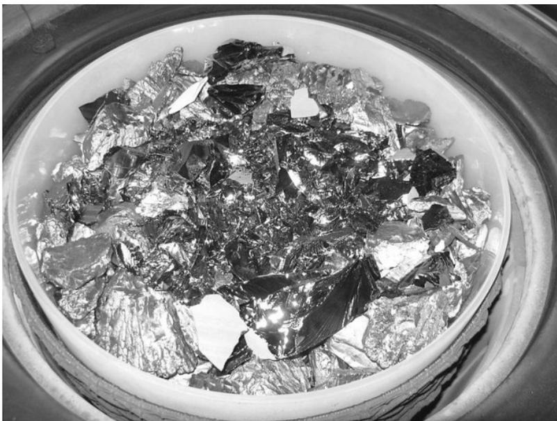
Рис. 1.3.7. Необожженный поликристаллический кремний в тигле
