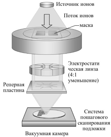
Рис. 1.8.10. Проекционная ионно-лучевая литография
