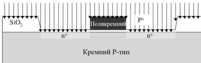
Рис. 1.14.2. Ионная имплантация примеси в области стока и истока для МОП-транзисторов
