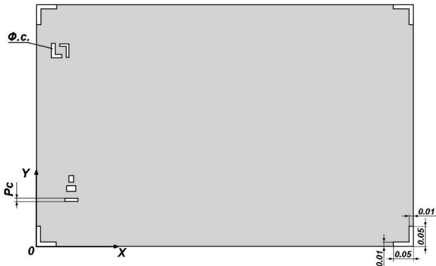
Рис. 3.2.27. Пример оформления чертежа топологического слоя микросхемы при отсутствии на шаблоне смены тональности на границах поля кристалла
