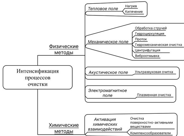
Рис. 1.56. Классификация способов интенсификации процессов очистки
