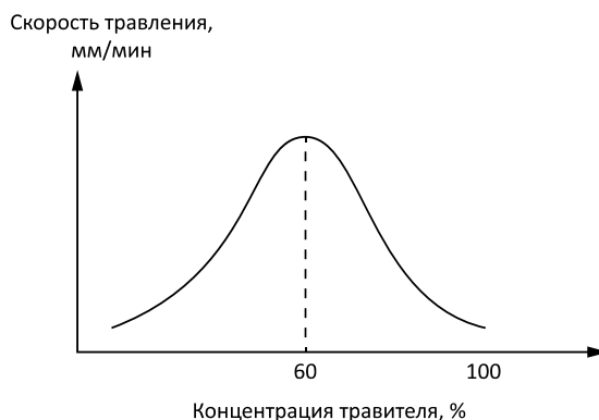
Рис. 1.128. Зависимость скорости травления от концентрации травителя[48].
