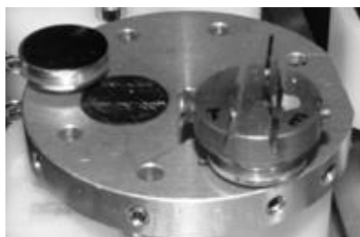
Рис. 2.41. Держатели на предметном столике с закрепленными образцами
