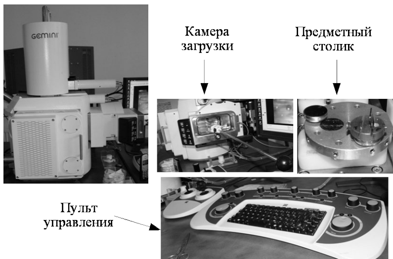
Рис. 2.40. Лабораторный стенд на базе растрового электронного микроскопа Zeiss Gemini Supra 55
