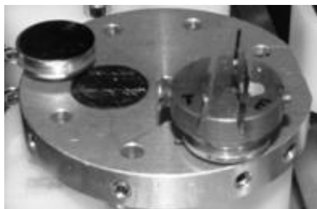
Рис. 2.43. Держатели на предметном столике с закрепленными образцами
