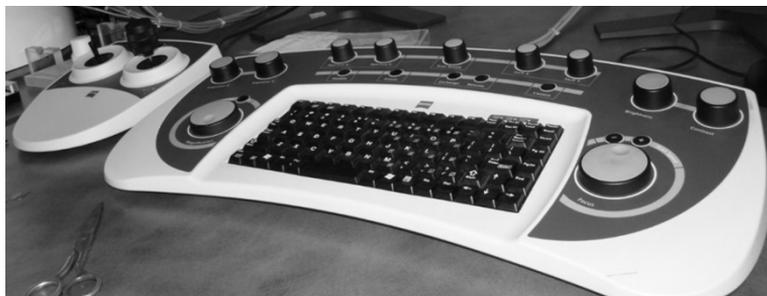
**Рис. 2.44.** Средства управления растровым электронным микроскопом
