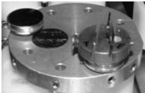
Рис. 2.54. Держатели на предметном столике с закрепленными образцами
