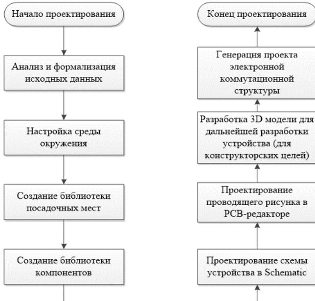
**Рис. 1.17.** Алгоритм проектирования коммутационных структур
