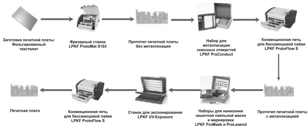
Рис. 1. 32. Изготовление макета ПП с использованием комплексного лабораторного производственного оборудования LPRF
