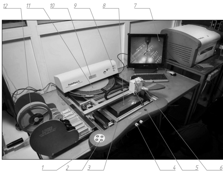
Рис. 1. 41. Внешний вид установки монтажа КМП
