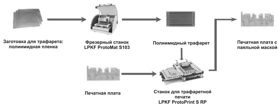
Рис. 1. 37. Получение ПП с паяльной маской с использованием комплексного лабораторного производственного оборудования LPRF
