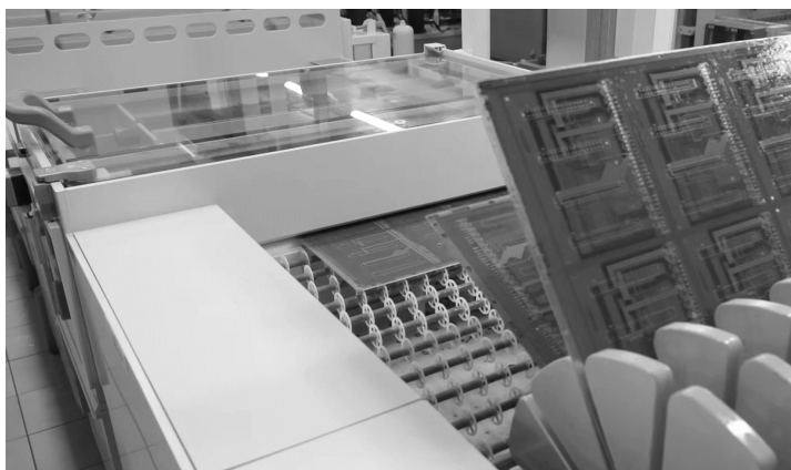
Рис. 1.53. Установка для нанесения флюса: слева ванная, в которой горизонтально расположенные, предварительно очищенные заготовки покрываются флюсом, справа – конвейер, по которому заготовки переходят на следующий этап (непосредственно горячее лужение)
