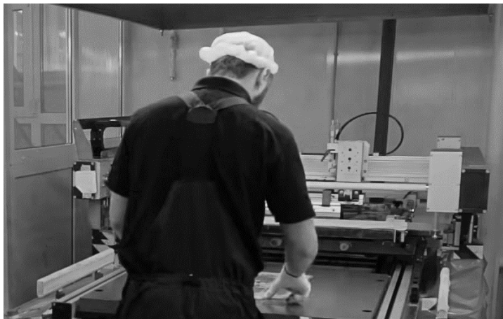
Рис. 1.51. Сеткографическая установка нанесения жидкой паяльной маски: стадия загрузки заготовки в установку
