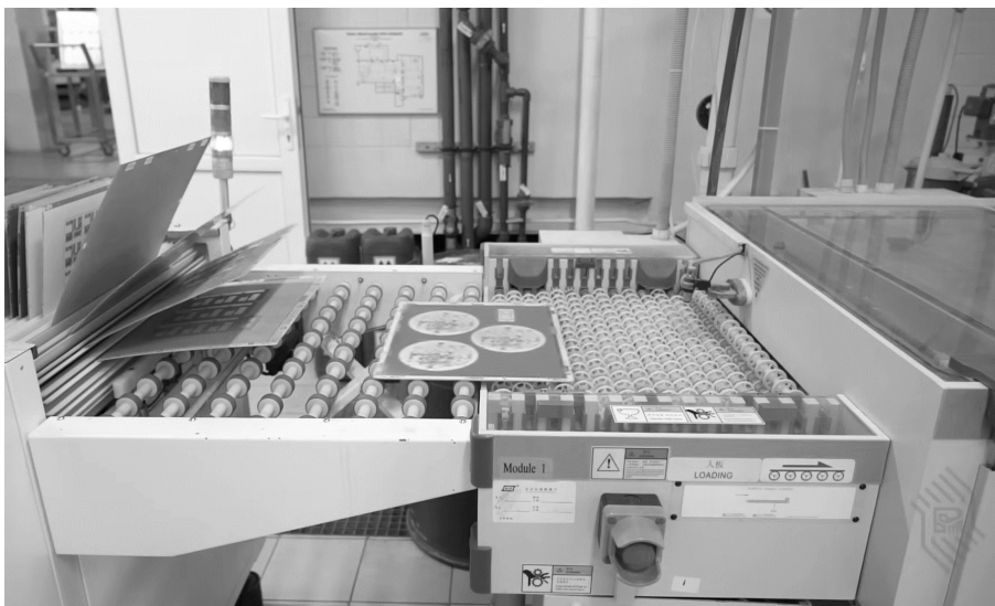
Рис. 1.50. Горизонтальная конвейерная линия травления (слева – конвейер для перемещения заготовок, справа – ванная для травления)
