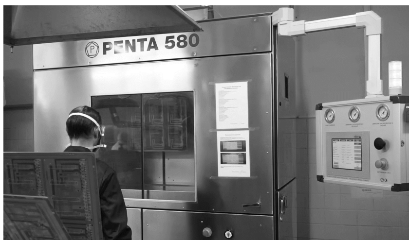
Рис. 1.54. Установка горячего лужения: заготовка погружается вниз в ванную с расплавленным припоем, после чего поднимается и излишки припоя удаляются воздушным методом.
