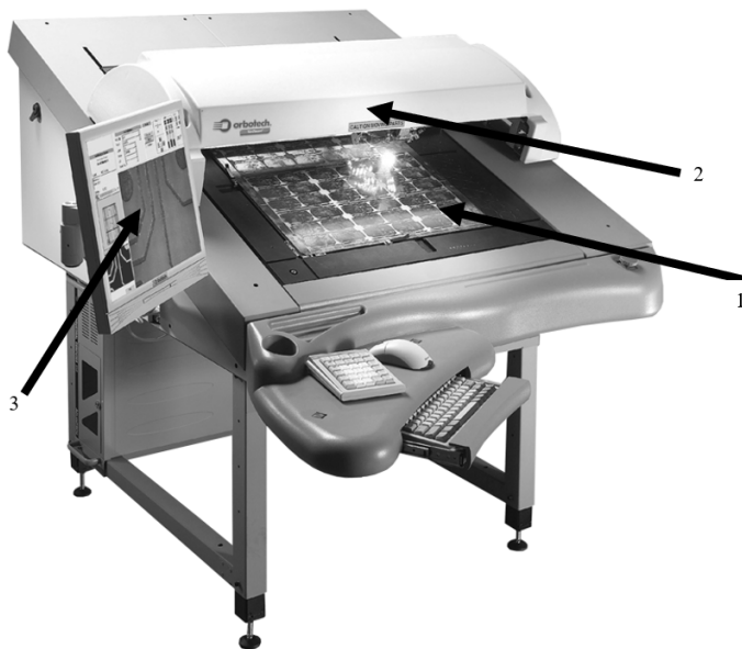
Рис. 1. 55. Установка оптического контроля:
