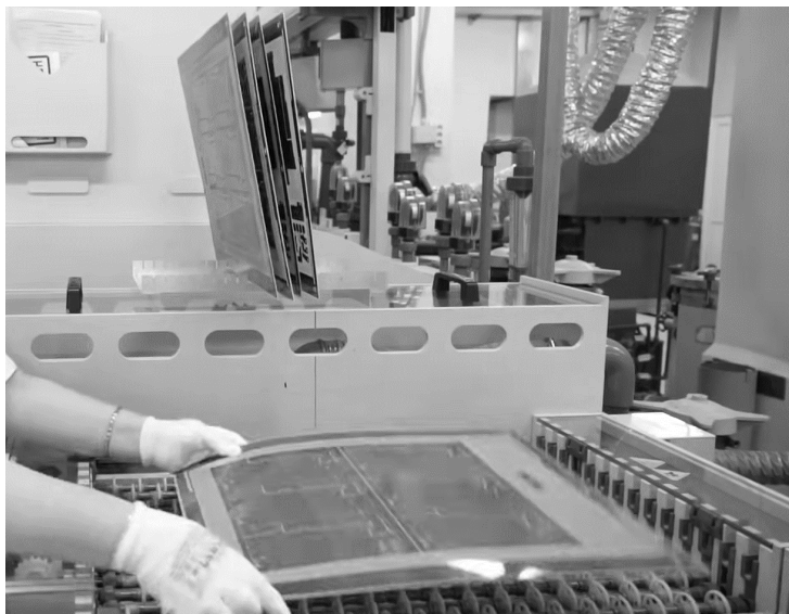
Рис. 1.49. Модульная линия конвейерного типа с ручной загрузкой
