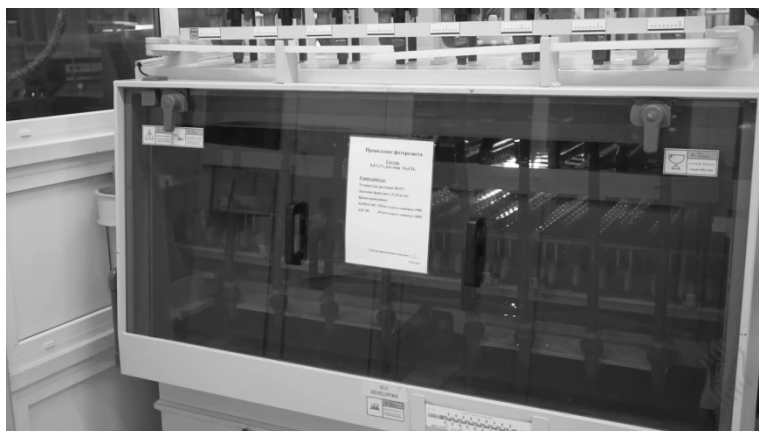
Рис. 1.48. Установка химической обработки (проявление рисунка схемы)
