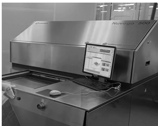
Рис. 1.47. Установка прямого лазерного экспонирования
