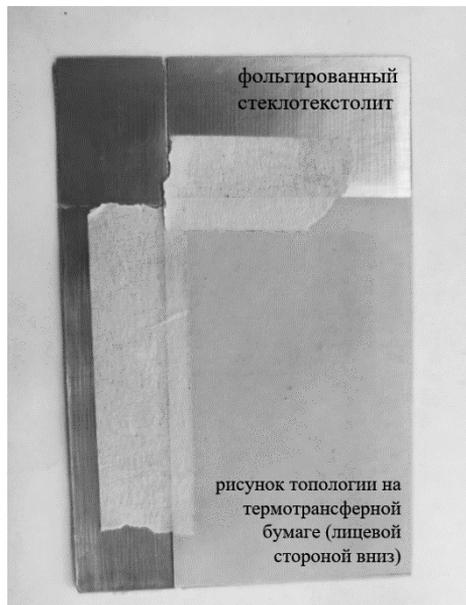
**Рис. 2.4.** Наложение рисунка на заготовку и его закрепление
