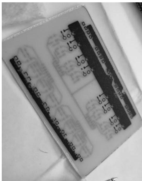
**Рис. 2. 11.** Внешний вид готовой печатной платы до удаления тонера
