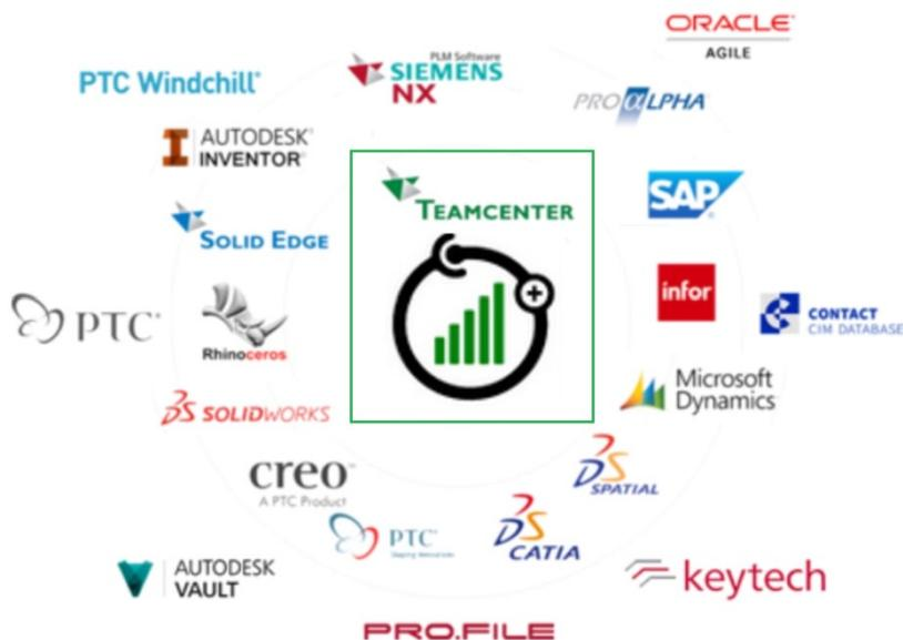
Рис. 1.3. Направления интеграции системы Teamcenter с CAD, PDM, PLM и ERP-системами
