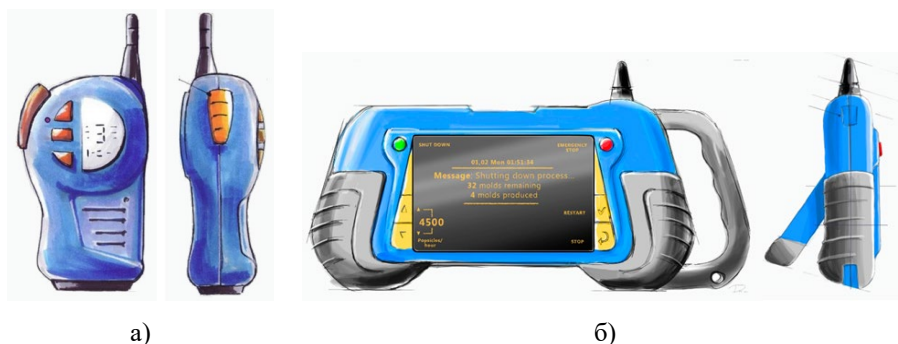
Рис. 1.34. Исходные данные – дизайнерские эскизы изделий электронной аппаратуры: портативная радиостанция (а); пульт управления промышленным оборудованием (б)
