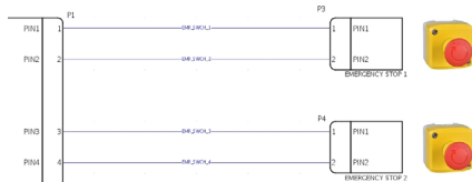
Рис. 2.24. Электрическая цепь подключения кнопки аварийного останова в модуле Wiring Design: вид схемы до создания цепи (а); вид фрагмента схемы после создания цепи (б)
