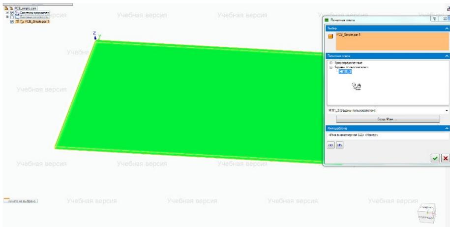
**Рис. 2.115.** Применение условия «Печатная плата» к упрощенной 3D-модели печатной платы
