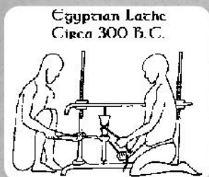
Древнеегипетский токарный станок приблизительно 300 век до нашей эры
