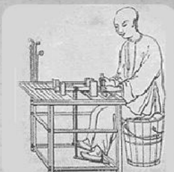
Древнекитайский токарный станок с ножным приводом
