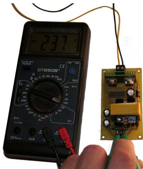
Рисунок 13 – Значение выходного напряжения по результатам эксперимента
