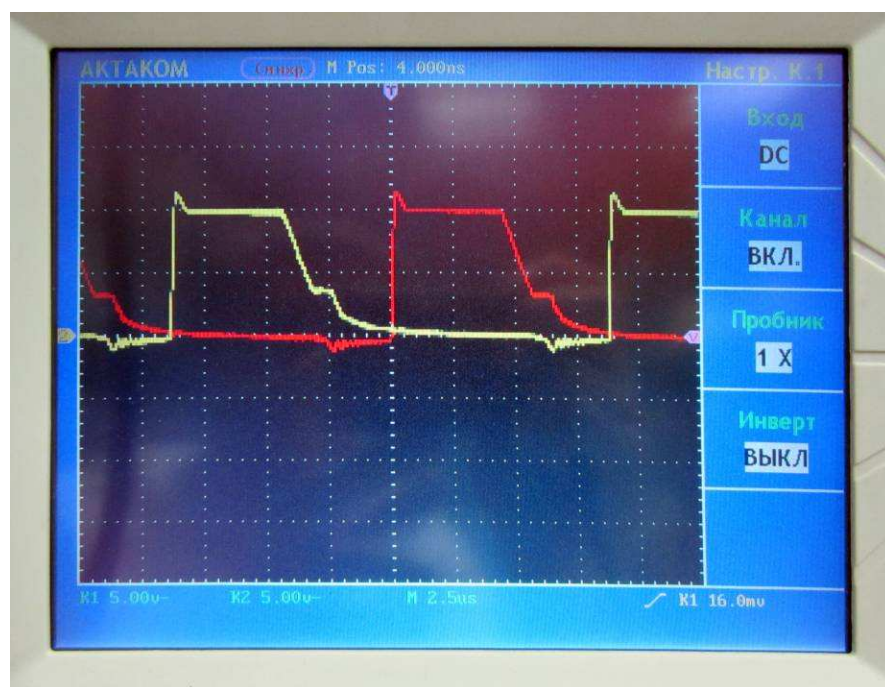
Рисунок 12 – Диаграмма напряжений на затворах транзисторов T1 и T2
