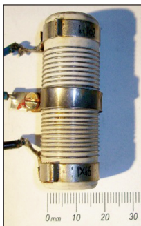
Рис. 2. Резистор без защитного слоя
