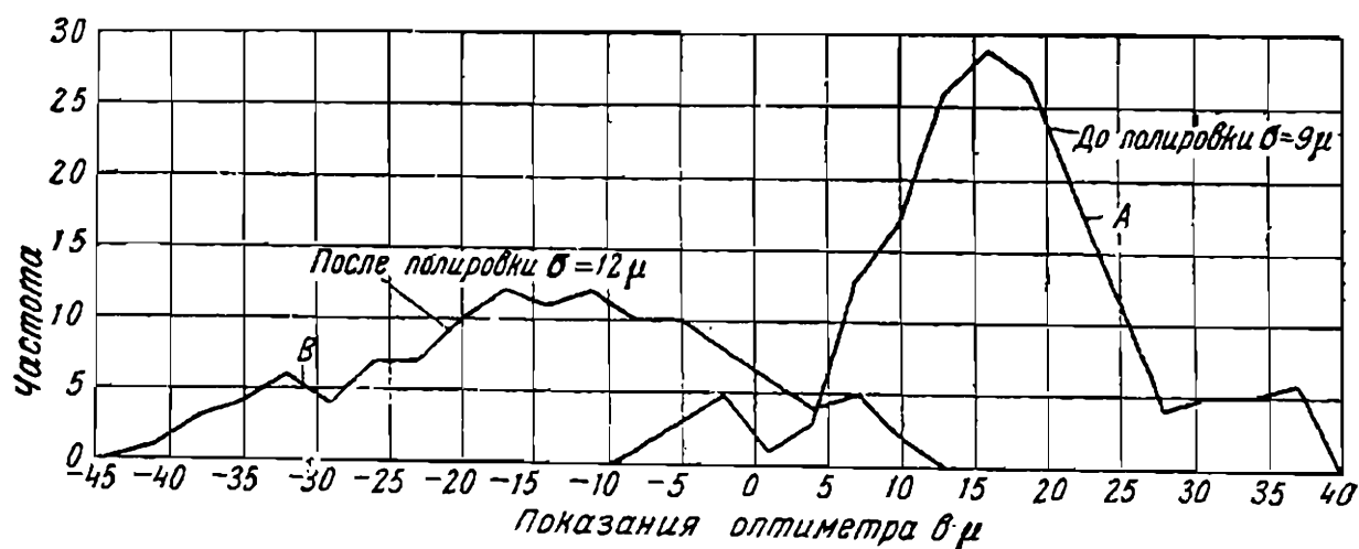
Фиг. 17. Кривые распределения диаметров цапф осей центрального триба до отделки и после.
