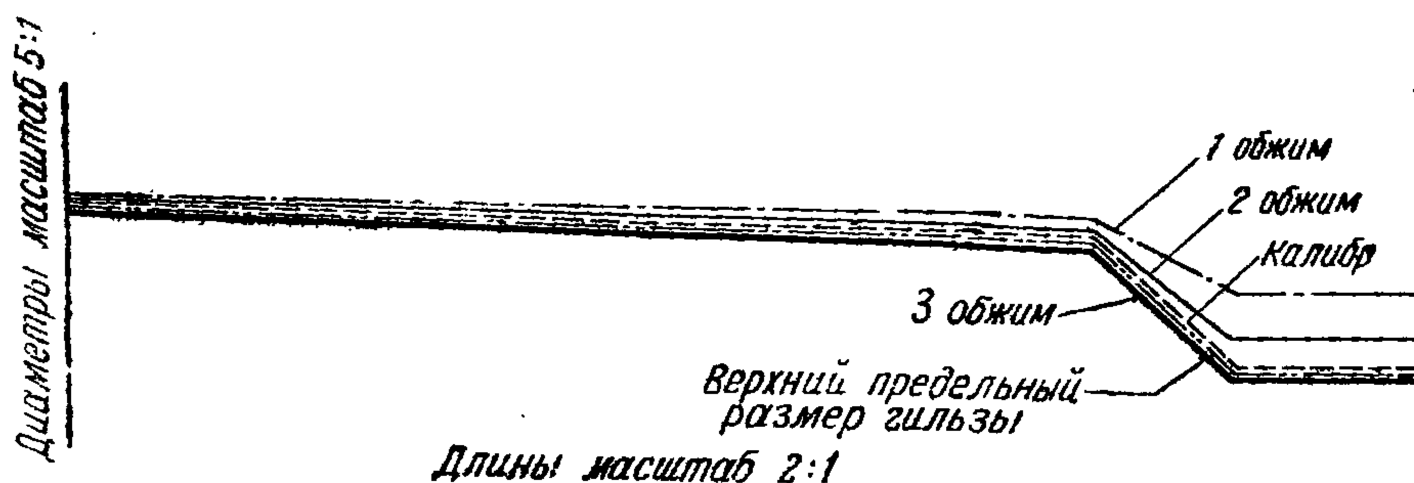
Фиг. 167. Графическое построение обжимных матриц.
