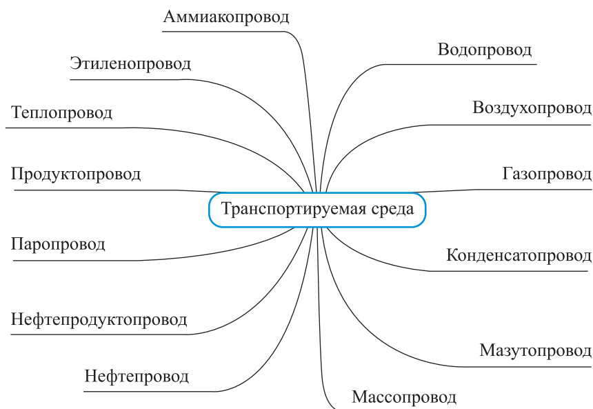
Рис. 1.1. Классификация трубопроводов по видам транспортируемых сред
