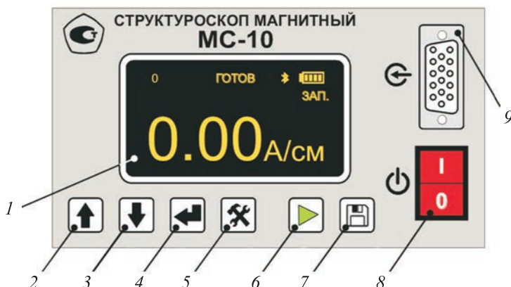
Рис. 4.4. Органы управления магнитного структуроскопа МС-10:
