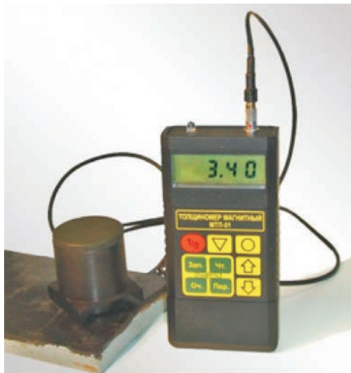
Рис. 6.1. Магнитный толщиномер покрытий труб МТП-01
