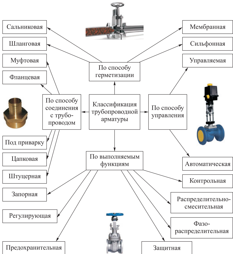
Рис. 1.4. Классификация трубопроводной арматуры
