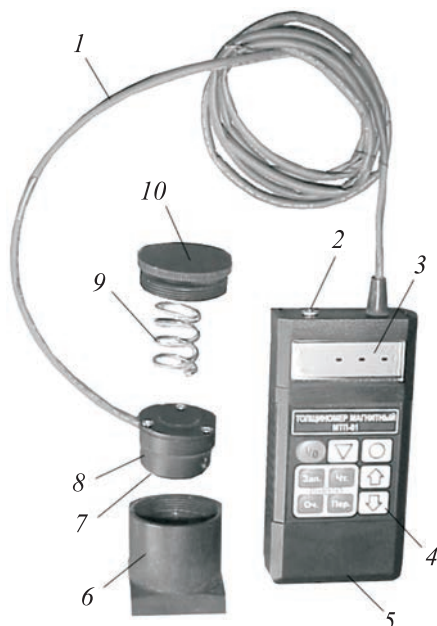
Рис. 6.3. Общий вид магнитного толщиномера МТП-01:
