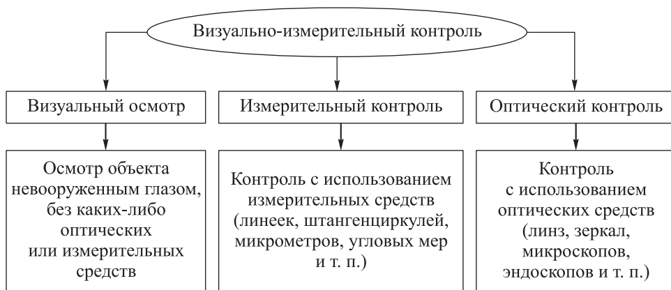
Рис. 1.12. Классификация систем визуально-измерительного контроля
