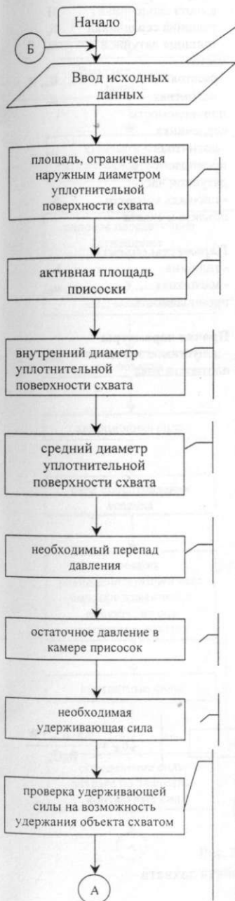
Рис. 5. Алгоритм расчета конструктивных параметров и усилий вакуумных устройств захвата 15
