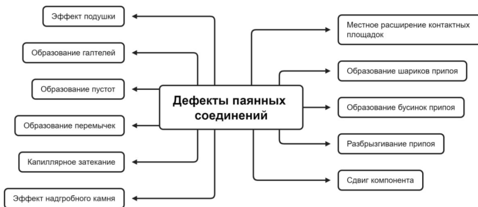
Рис. 1. 105. Основные дефекты паяных соединений
