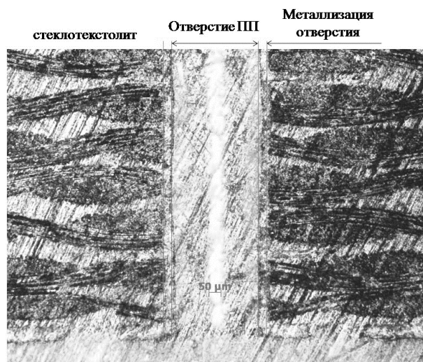
Рис. 1. 124. Вид микрошлифа ПП с качественным отверстием
