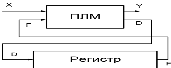
Рис. 11.1. Структура УА на основе ПЛМ и регистра.
