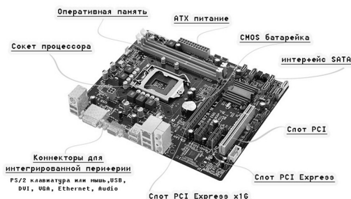
Рис. 17.1. Общий вид типовой материнской платы персонального компьютера. Размещение элементов на материнской плате.
