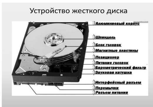
Рис. 21.1. Устройство накопителя жёсткого магнитного диска.
