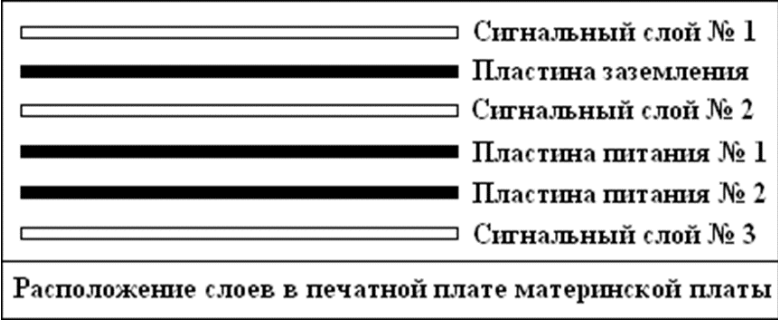
Рис. 17.2. Расположение слоев в печатной плате материнской платы.
