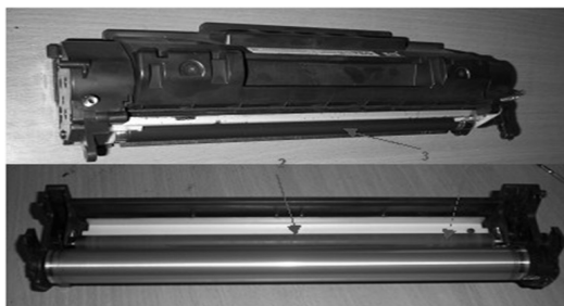
Рис. 23.1. Структура картриджа лазерного принтера.
