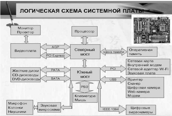
Рис. 17.3. Логическая схема системной платы.
