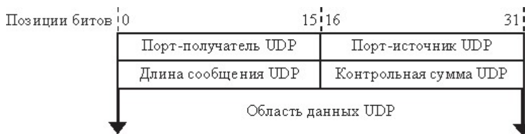
Рисунок 4 – Структура UDP-заголовка
