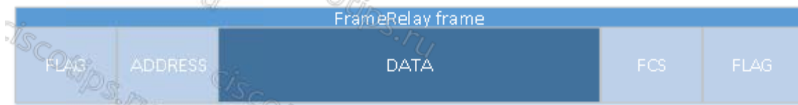
Рис. 2 – формат кадра Frame Relay.
