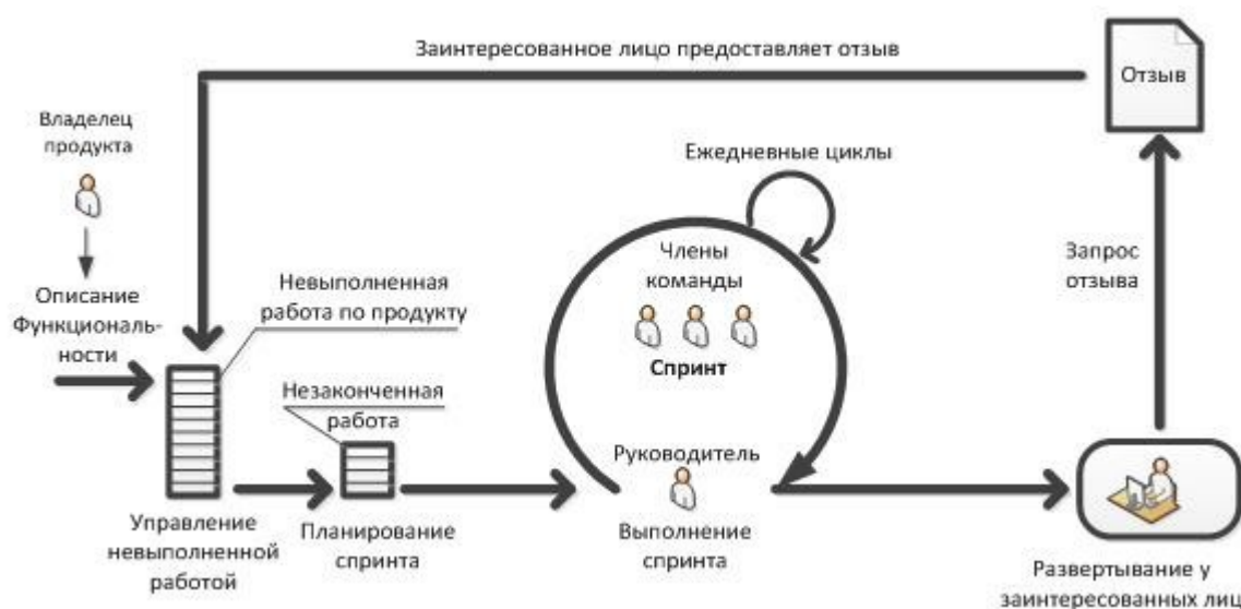
Рисунок 5 - Жизненный цикл проекта при его разработке по методологии Scrum
