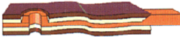
Рис. 23. Гибкая печатная плата с местным ужесточением
