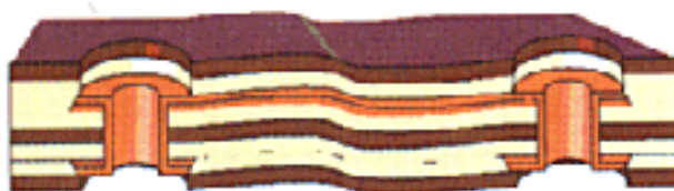
Рис. 20. Двухсторонняя гибкая печатная плата
