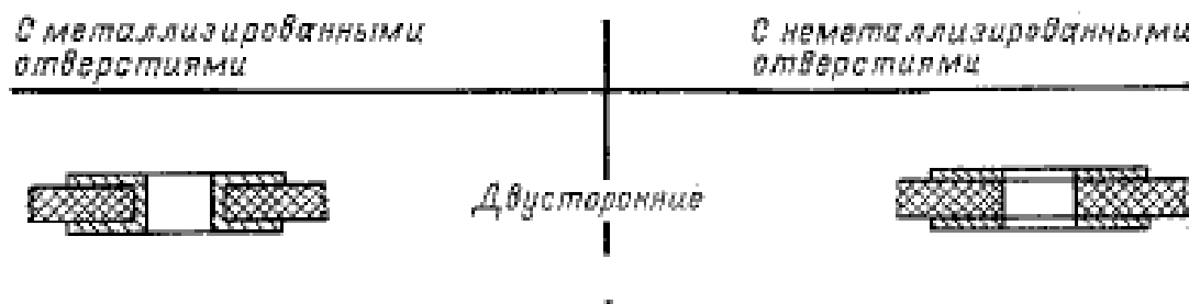
Рис. 14. Поперечное сечение двухсторонней печатной платы
