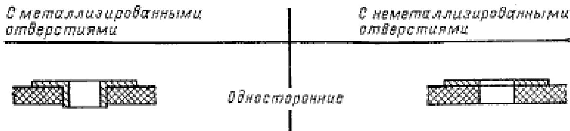
Рис. 13. Поперечное сечение односторонней платы
