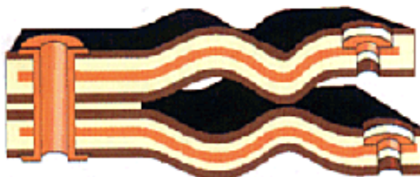
Рис. 21. Многослойная гибкая печатная плата
