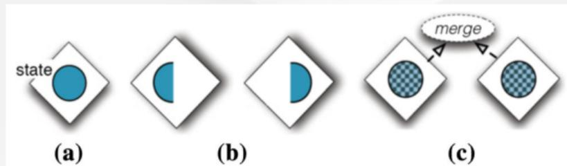
**a** - элемент состояния, **b** - состояние, разбитое на два раздела, **c** - множественные экземпляры частичного состояния.
