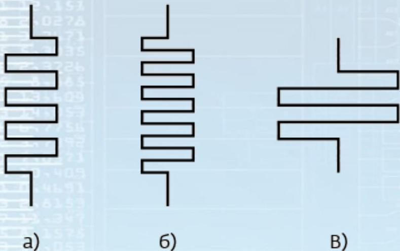
При формировании зигзагообразных линий следует учитывать наличие перекрестных связей между соседними изломами проводника. Перекрестные связи в длинных изломах приводят к значительным искажениям сигнала.
