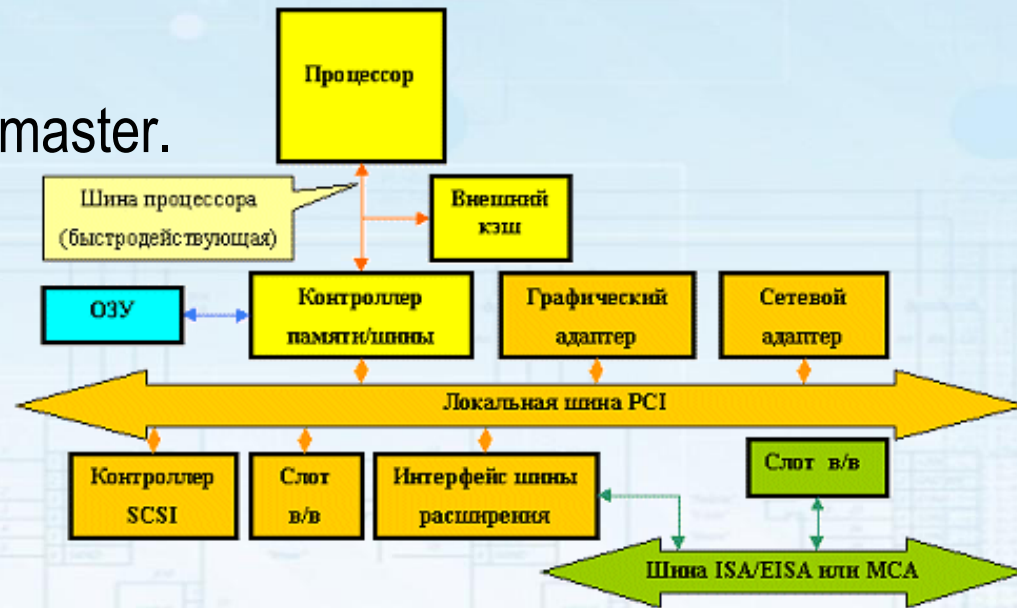
Архитектура компьютера с шиной PCI
