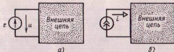
Рис. 1.5. Элементарные активные двухполюсники: а) источник напряжения; б) источник тока
