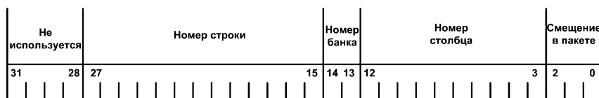
Рис. 6. Пример трансляции 32-разрядного физического адреса в адреса строки, банка и столбца
