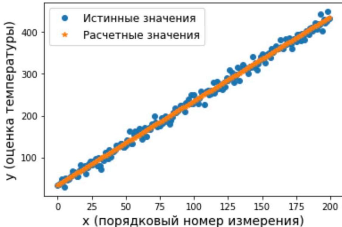
Таким образом удалось выполнить оценку параметров модели, которая описывает процесс изменения температуры в печи с минимальной ошибкой. Выведенные выражения (5) – (7) и запрограммированные по ним три алгоритма, реализующие МНК при обработке одного набора измеренных температур, хотя и отличаются видом конечных выражений, дают одинаковые оценки.
