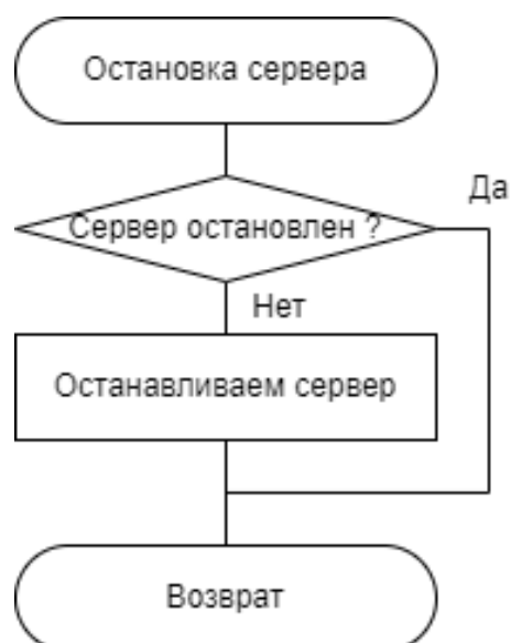
Рисунок 3 – Схема алгоритма метода остановки сервера
