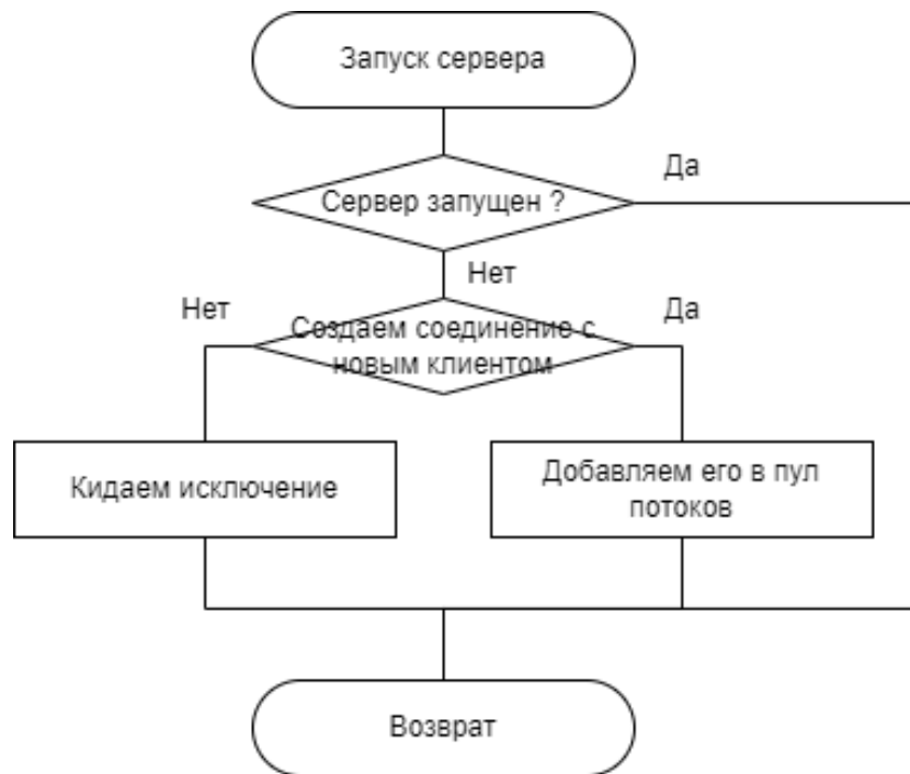
Рисунок 1 – Схема алгоритма метода создания сервера с применением «Pool Thread»
