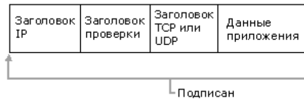
Рисунок 6 - Пакет IP с заголовком проверки АН
