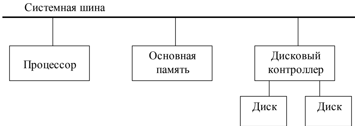
Рис. 6.8. Соединение дисков с системной шиной
