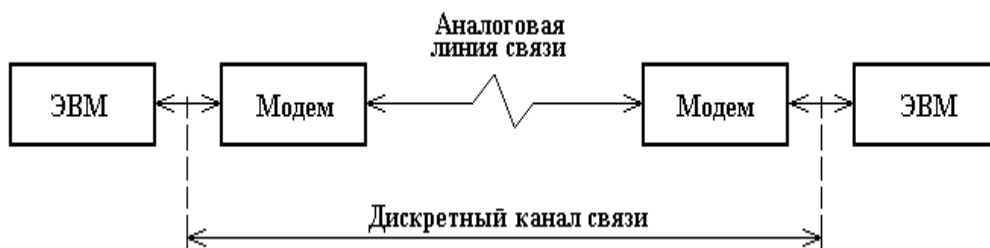
Рис. 7.3. Дискретный канал связи
