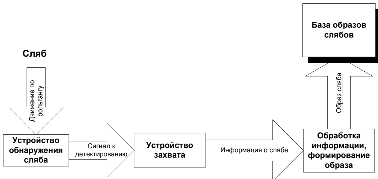
Рис. 3. Функциональная схема устройства детектирования сляба
