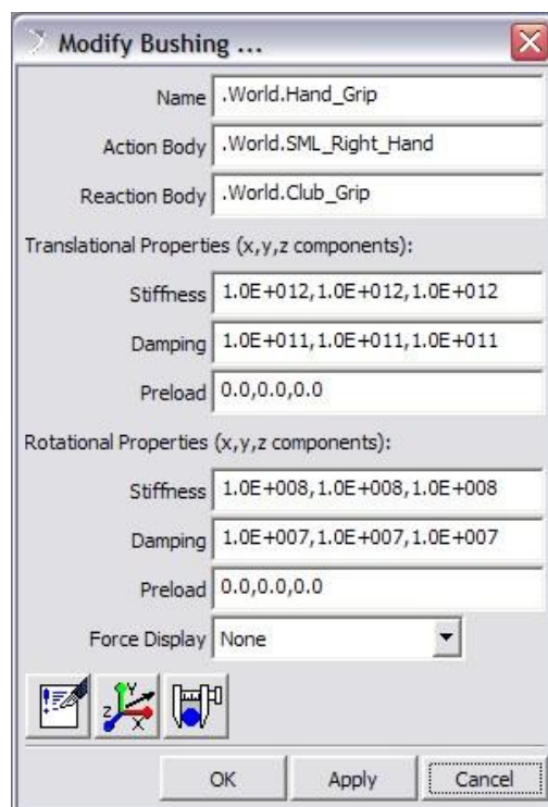
Рис. 5. Параметры переходного элемента (bushing)
