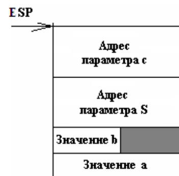
Рисунок 3.2 – Состояние стека после записи параметров
