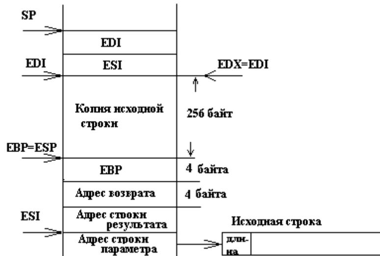
Рисунок 3.14 – Структура стека при работе функции Dell1
