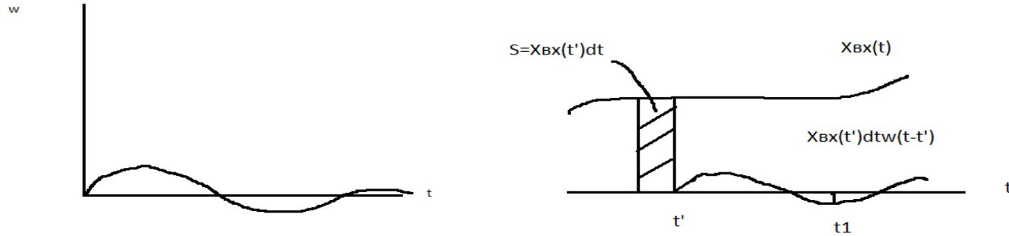
Рис. Реакция на выходе в момент  $t_1$  как сумма реакций на импульсы в интервале  $0 \leq t' \leq t_1$ .
