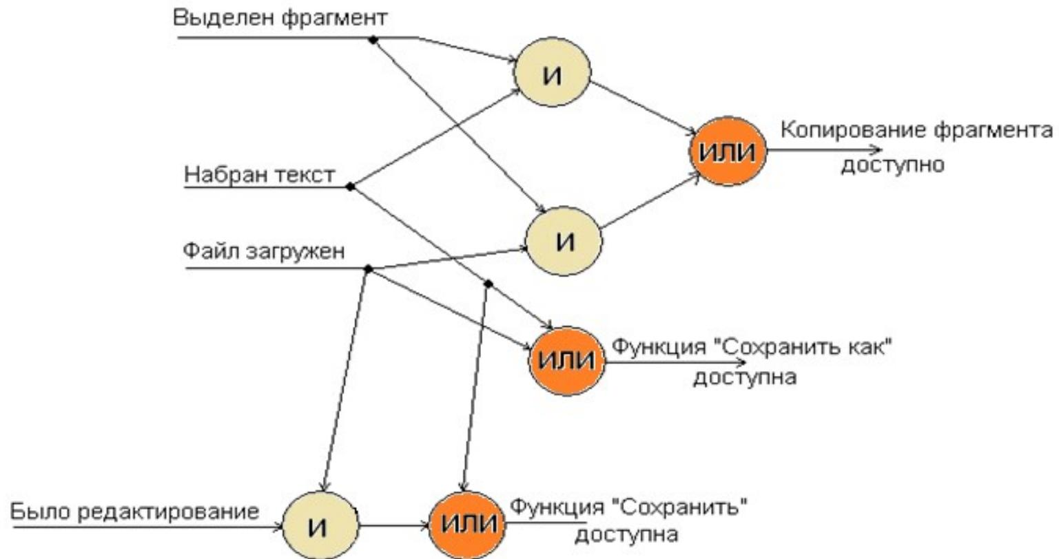
Логическая схема управления редактированием.
